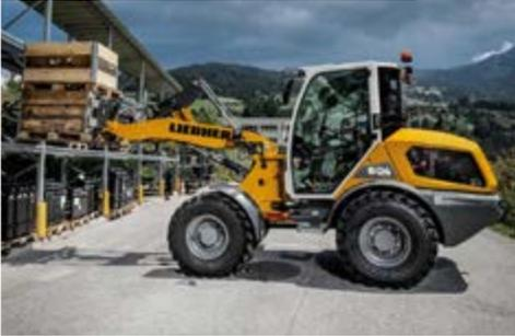
Grundgerät L 504 Compact G8.0-D ohne Anbauteile
