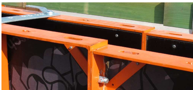
Die in den Elementrahmen integrierten Langlöcher ermöglichen einen Höhenversatz bei unebenen Aufstellflächen von bis zu 2 cm.
