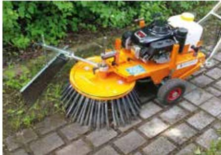
Ein leistungsstarkes handgeführtes Gerät zur mechanischen Wildkrautbeseitigung mit **hydrostatischem Fahrtrieb**.
