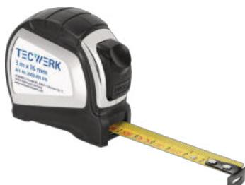
**Taschenrollbandmaß Länge 5 m Breite 19 mm mm/cm EG II 2K Automatic TECWERK Stahlband mattgelb lackiert · Aufdruck mit beidseitiger Band-Graduierung · eine Seite horizontal, eine Seite vertikal · Selbst-Arretierungs-System (Rücklauf auf Tastendruck) · Länge 5 m und 8 m mit Doppelendhaken · verchromtes Kunststoffgehäuse mit Teil-Gummiüberzug · EG-Genauigkeitsklasse II**
